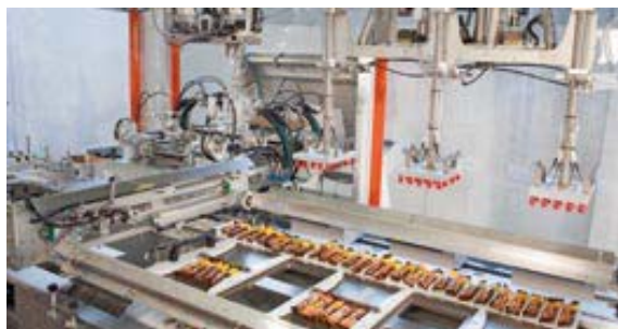
Station de remplissage des barquettes avec prise des produits par le dessus
