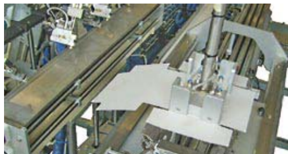
Station de formation des barquettes
