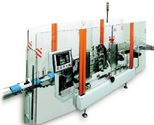
Plan fermeuse type pour box 1 seul rabat (BC1) (version miroir disponible)
